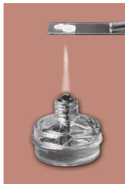
Рис. 3.10. Выпаривание воды из раствора
