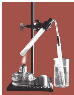
Рис. 3.6. Дистилляция (перегонка) воды в простейшем приборе
